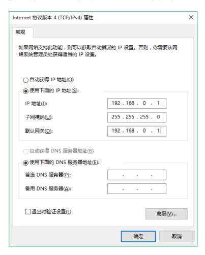
网络接口需要安装自带的 UDP 测试工具,安装好后"新建连接",选择 UDP 协议,并把目标 IP 设置成 192.168.0.10,目标端口设置为 30000,本机端口为 30001。点击创建,点击连接,即可通过软件发送数据到 iCore4,iCore4 接收到数据后会原封不动发向计算机。如图,
