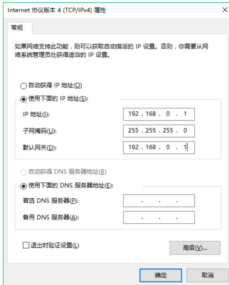
网络接口需要安装自带的 UDP 测试工具，安装好后“新建连接”，选择 UDP 协议，并把 IP 设置成 192.168.0.10，目标端口设置为 30000，本机端口为 30001。点击创建，点击连接，即可通过软件发送数据到 iCore4T，iCore4T 接收到数据后会原封不动发向计算机。如图，
